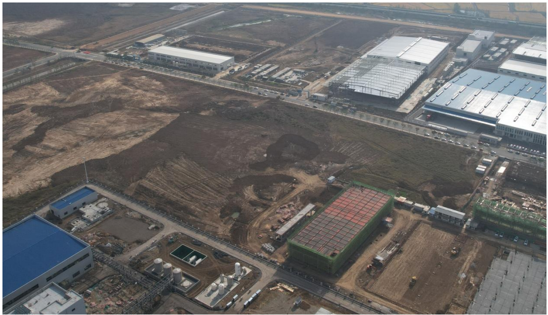
M 地块子美路南侧工业场地土地整治、表土回覆进行中
